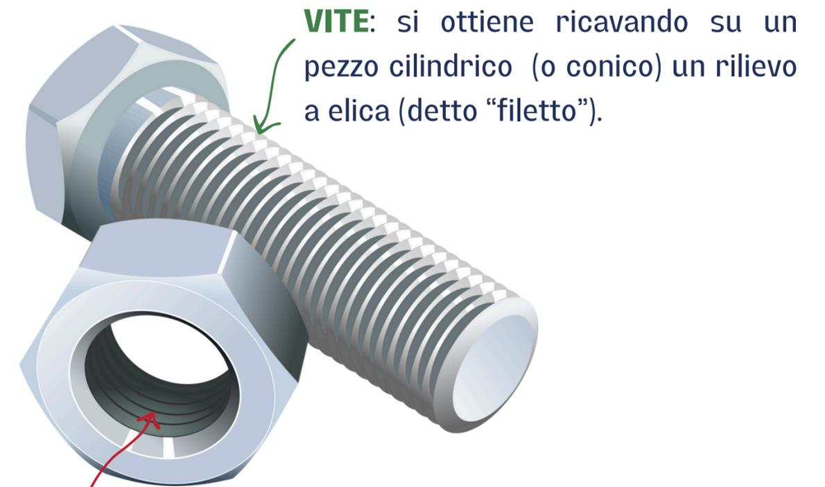
**VITE:** si ottiene ricavando su un pezzo cilindrico (o conico) un rilievo a elica (detto "filetto").
